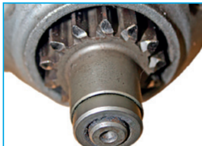
Střední opotřebení opakovaným vysouváním.
