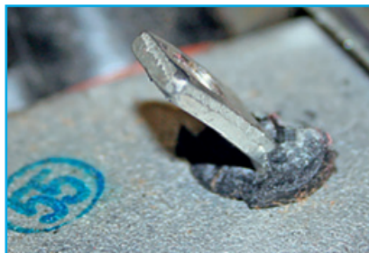
Rozpojení kontaktu může způsobit zkrat na kostru.
