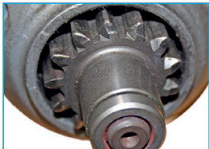
Mírné opotřebení opakovaným vysouváním (způsobí poškození setrvačnicku a problémy při zasouvání pastorku do ozubení vence setrvačnicku).
