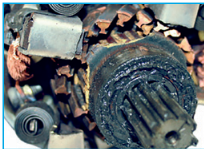
Oddělené lamely komutátoru.
