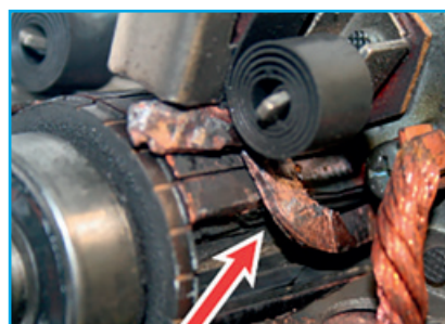
Lamely komutátoru jsou uvolněné, vyvýšené a ohnuté (deformované).
