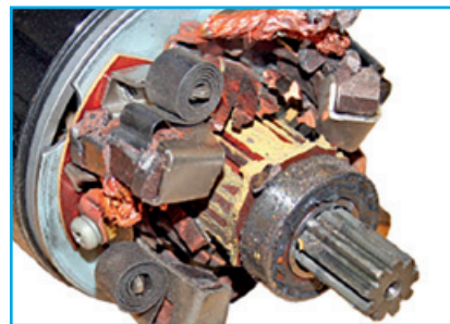
Poškození komutátoru, uhlíků a jejich držáků.
