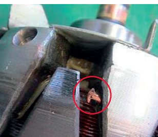
Defecțiunea firelor din bobina rotorului
