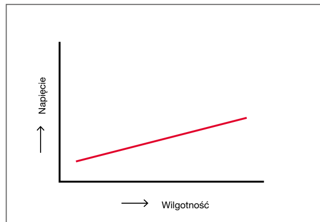
Rys. 6.11 Napięcie wymagane do wytworzenia iskry wzrasta wraz ze wzrostem wilgotności
