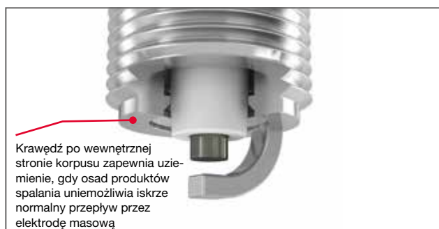
Rys. 7.11 Elektroda ze szczeliną do wyładowań półpowierzchniowych
