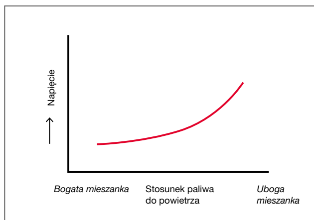
Rys. 6.9 Napięcie wymagane do wytworzenia iskry wzrasta w uboższych mieszankach
